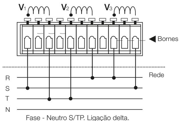
**Sensor de Tensão (Tensão 50-500 V CA) - Fase - Fase com TP - Ligação Delta**
