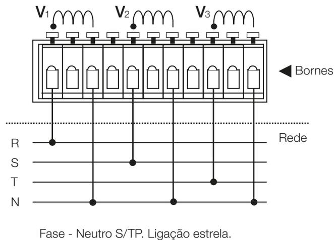
**Sensor de Tensão (Tensão 50-500 V CA) - Fase - Neutro com TP - Ligação Estrela**
